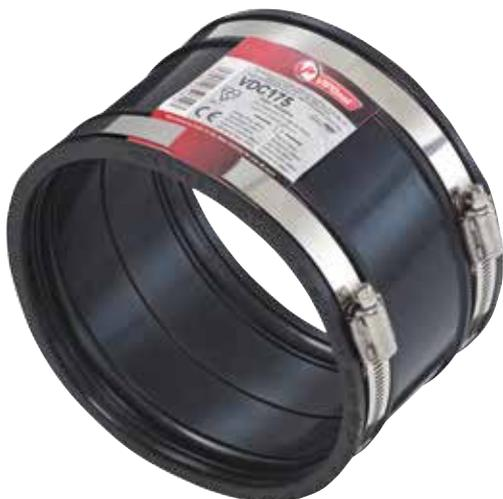
VIPSeal™ Drainagekupplungen sind mit derselben Elastormanschette ausgestattet wie Standardkupplungen, aber ohne die zusätzliche Verstärkung durch ein mittleres Band. Zwar ist normalerweise eine Standardkupplung empfehlenswert, aber in Situationen, wo reduzierter Widerstand gegenüber schwerer Erdlast oder instabilen Grund vorliegt, kann die Drainagekupplung eingesetzt werden.
